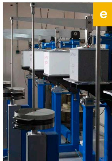
**La déformation d'un isolant à long terme peut avoir une influence sur ses performances.** L'essai de fluage permet de classifier les caractéristiques du produit au regard des exigences des règles de mise en œuvre.
